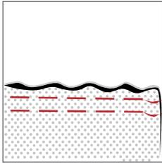
Stechen sie in einfacher Stofflage 1 mm rechts und links von der zu nähenden Naht mit großem Stich. Benutzen Sie für Ober- und Unterfäden verschiedene Farben. Fixieren Sie die Ober- und Unterfäden an einem Ende der Naht. Ziehen Sie gleichmäßig an den Unterfäden des anderen Ende. Die verschiedenen Farben erleichtern dies. Schieben Sie den Stoff zusammen und fixieren auch hier die Fäden.
