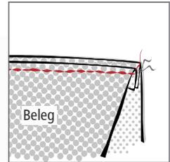
Ansicht von der Belegseite. Die Naht liegt 2 mm unterhalb der Bruchkante und ist von der rechten Seite des Werkstücks nicht sichtbar.
