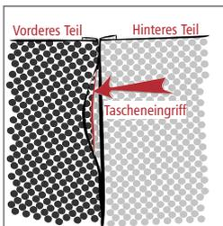
Die Ansatznaht (rot) des vorderen Taschenbeutel ist nun von außen nicht sichtbar, sie liegt im inneren der Tasche. Der hintere Taschenbeutel ist teil der Seitennaht.
