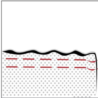
Steppen sie in einfacher Stofflage 1 mm rechts und links von der zu nähenden Naht mit großem Stich. Benutzen Sie für Ober- und Unterfäden verschiedene Farben. Fixieren Sie die Ober- und Unterfäden an einem Ende der Naht. Ziehen Sie gleichmäßig an den Unterfäden des anderen Ende. Die verschiedenen Farben erleichtern dies. Schieben Sie den Stoff zusammen und fixieren auch hier die Fäden.
