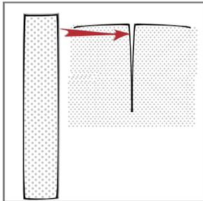
Zum Einfassen eines Ärmelschlitzes benötigen Sie einen Stoffstreifen von 3 cm Breite und 2\*der Schlitzlänge. Nach jedem Arbeitsschritt bleibt die Nadel im Stoff und das Nähmaschinenfüßchen wird angehoben.
