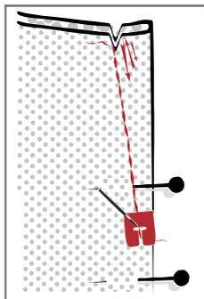
Sie beginnen am breiten Ende des Abnähers zu nähen, ziehen Sie die Stecknadel raus und sichern Sie die Naht mit einigen Rückstichen. Nähen Sie bis ca. 2 cm vor Ende des Abnähers. Verringern Sie die Stichlänge, nähen Sie bis zum Ende des Abnähers, heben Sie das Füßchen und ziehen Sie den Stoff nach vorne, um etwas Faden zu gewinnen. Anschließend nähen Sie in der Nahtzugabe 4 Stiche und beenden die Arbeit. (s. Abb.) Zum Schluß bügeln Sie den Abnäher in Richtung Körpermitte.
