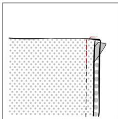
Für den oberen Abschluss ziehen Sie das Reißverschlussband in Richtung Nahtzugabe (Abb.5) und nähen Sie den Beleg und das Außenteil in Verlängerung der ersten Naht (Abb. 2) zusammen. Der Beleg liegt unten.
