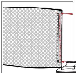
Teilen Sie den Reißverschluss und legen Sie ihn rechts auf rechts an die Verschlusskante (Abb. 2). Die Zähnchen liegen knapp neben der Nahtlinie, der Saum bleibt frei. Heften Sie den Reißverschluss ein damit er beim Nähen nicht verrutscht. Positionieren Sie das Füßchen entsprechend der Ausrichtung des Reißverschlusses. Steppen Sie vom Anfang bis zum Ende der Zähnchen (Pfeile) nah an den Zähnchen entlang. Bügeln Sie die Nahtzugabe um.
