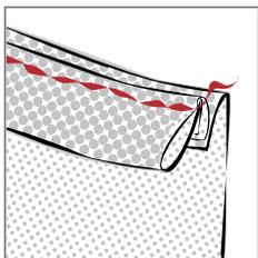
Jetzt den Streifen so nach innen klappen, dass die Nähte von außen nicht sichtbar sind und mit der Hand an den Nahtzugaben der Seiten-, Schulter- oder Abnähernähten festnähen.
