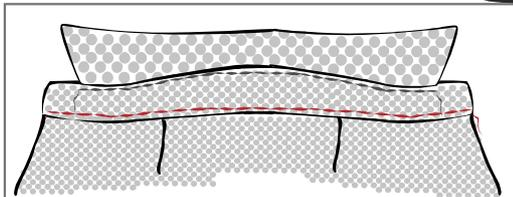
Bügeln Sie die Nahtzugaben in den Steg und stecken den inneren Steg fest und steppen von der rechten Hemdseite auch hier von der Mitte ausgehend über die gesamte Steglänge.
