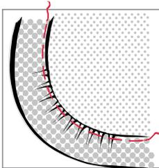
Bei einem gebogenen Saum wird die Mehrweite des Saumumbruchs eingehalten. Dazu nähren Sie an der Umbruchkante
