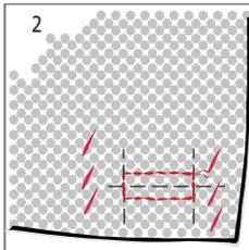
Nähen Sie von rechts ein Rechteck mit einer einfachen Naht. Manche modernen Nähmaschinen haben dafür auch schon ein Automatikprogramm.
