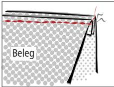
Ansicht von der Belegseite. Die Naht liegt 2 mm unterhalb der Bruchkante und ist von der rechten Seite des Werkstücks nicht sichtbar.
