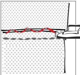
Nähte, bei denen die Nahtzugaben in eine Richtung gebügelt werden, können zusammen versäubert werden. Schließen Sie erst die Naht, bügeln Sie die Nahtzugaben in eine Richtung und nähen Sie beide Stofflagen mit Zick-Zack- oder Overlockstich zusammen.
