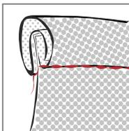
Die Nahtzugaben von **Jacken und Mänteln**, die nicht gefüttert werden, können Sie mit Schrägband versäubern. (s. Nähte-Kanten-Säume, Einfassen mit selbst zugeschnittenem Schrägband).
