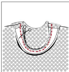
Beim Halsbeleg schließen Sie erst die Schulternähte der Belegteile. Stecken Sie den Halsbeleg rechts auf rechts auf den Halsausschnitt und nähen sie die Halsrundung zusammen. Schneiden Sie die Nahtzugaben auf ca. 0,5 cm zurück und schneiden Sie in den Rundungen bis kurz vor die Stepplinie ein.
