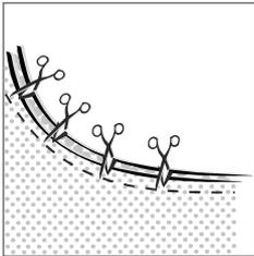
**Geschwungene Nähte** werden in gleichmäßigen Abständen eingeschnitten, gebügelt und zusammen versäubert. Beim Versäubern dehnen Sie die Nahtzugabe und nähen im Zick-Zack über die Einschnitte hinweg. Die Nahtzugabe bügeln Sie in die Richtung des größeren Radius.
